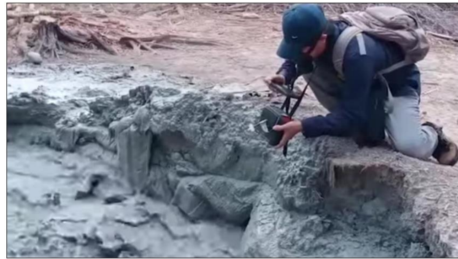
Gambar 4. Pengukuran komposisi kimia semburan gas menggunakan etektor gas drager xam 7000.
