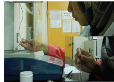
Penimbangan sedimen bubuk mesh 200 ke dalam kotak timah
