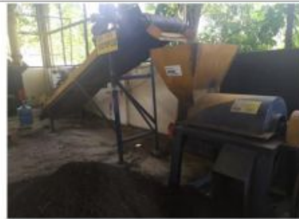
Rumah Kompos ITS (Alat Penyaring dan Penggiling Kompos)
