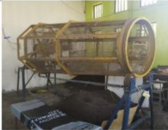
Rumah Kompos ITS (Alat Penyaring dan Penggiling Kompos)
