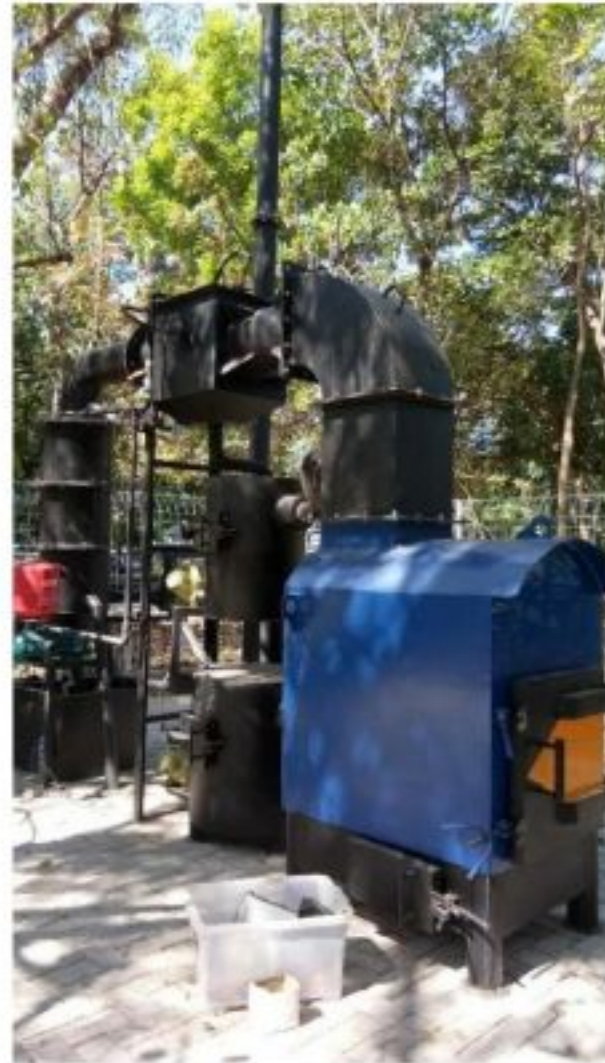
Insinerator (tahap Penelitian) untuk pembakaran sampah kemasan dengan kandungan aluminium foil
