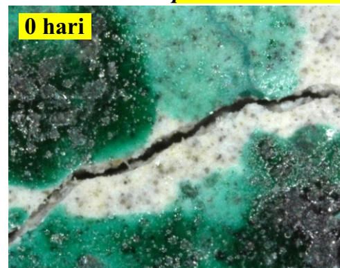
Variasi Agregat buatan pada benda uji balok Beton Normal pada Umur Healing 0 dan 100 hari
