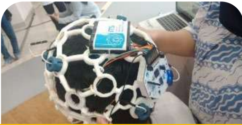
Gambar 4.4 Alat EEG rancangan tim ITS yang digunakan di kepala pasien stroke untuk menangkap sinyal listrik otak
