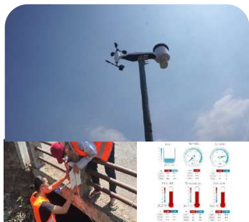
Gambar 3.125 Wujud ARR yang dipasang oleh tim KKN ITS di salah satu atap rumah warga Desa Tambaksumur, Sidoarjo
