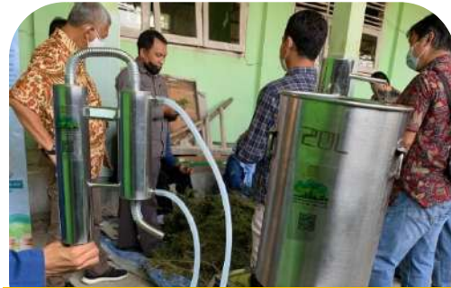
Gambar 3.14 Proses Destilasi Ekstrak Daun Kayu Putih Menjadi Minyak Kayu Putih
