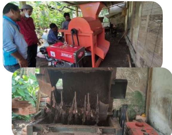
Gambar 3.39 Uji coba mesin penggiling kotoran kambing yang dirancang oleh tim KKN Abmas ITS
