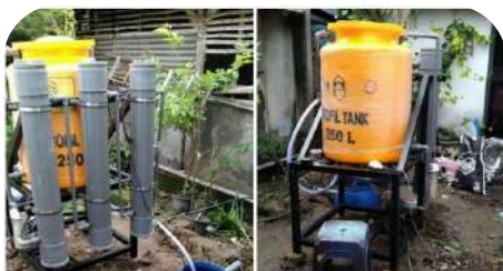
Gambar 3.25 Penerapan Adsorben Superadsorpsi pada pengolahan limbah pewarna batik
