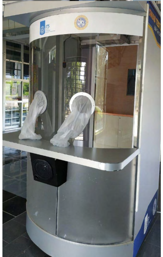
Gambar 4.19 Bilik Tes Swab ITS dilengkapi belalai lengan, pengeras suara untuk komunikasi, dan sinar UV untuk sterilisasi
