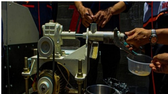
Gambar 4.26 Pengujian alat pengolah biji kemiri menjadi minyak kemiri yang dirancang oleh tim KKN dan Abmas mahasiswa ITS
