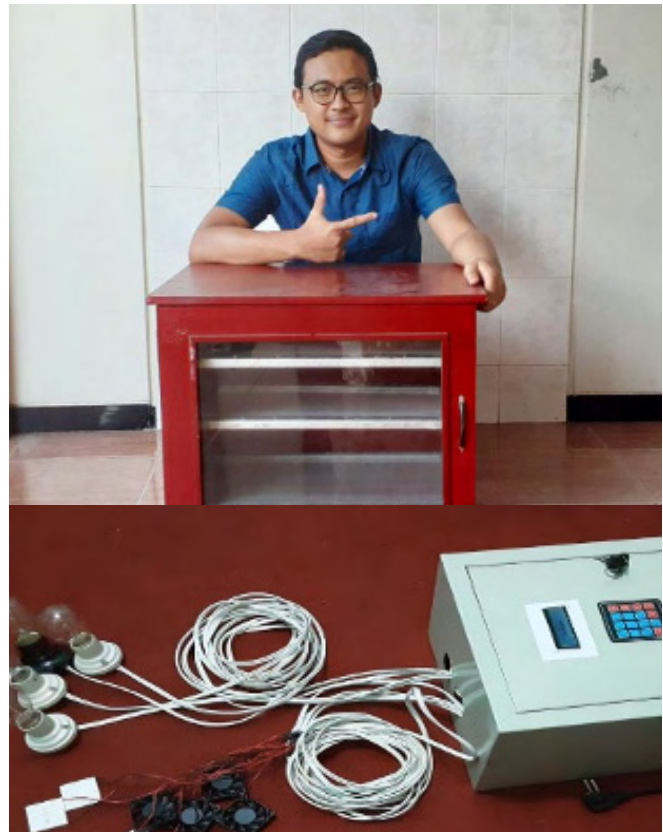
Gambar 4.25 Komponen utama alat pengering kerupuk otomatis.
