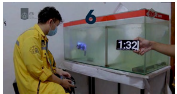
Gambar 3.118 Robot Glaucus Atlanticus saat demo memindahkan kelereng di dalam akuarium
