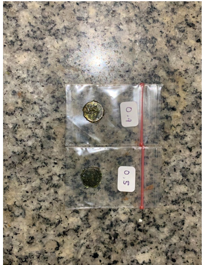
Gambar 3.71 Spesimen yang telah di-coating untuk campuran resin dan ekstrak kulit mangga
