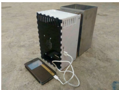
Inovasi Kompor multifungsi dan ramah lingkungan (Biocampstove) karya mahasiswa ITS. Selain memiliki fungsi utama sebagai kompor, perkakas ini juga bisa digunakan untuk mengisi daya baterai smartphone.
