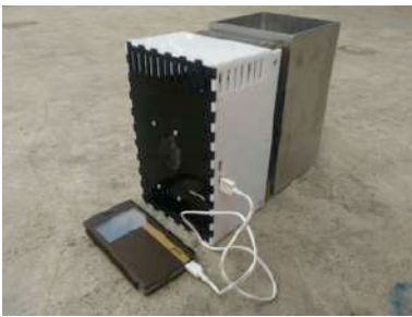
Inovasi Kompor multifungsi dan ramah lingkungan (Biocampstove) karya mahasiswa ITS. Selain memiliki fungsi utama sebagai kompor, perkakas ini juga bisa digunakan untuk mengisi daya baterai smartphone.
