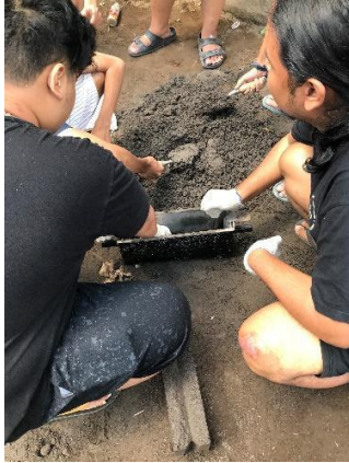
Gambar 4. Adonan dimasukkan ke dalam cetakan Batako
