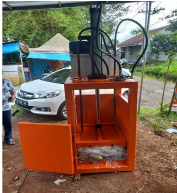
Gambar 8. Pengujian Pemadatan Sampah Anorganik Menggunakan Mesin Pemadat Sampah Anorganik
