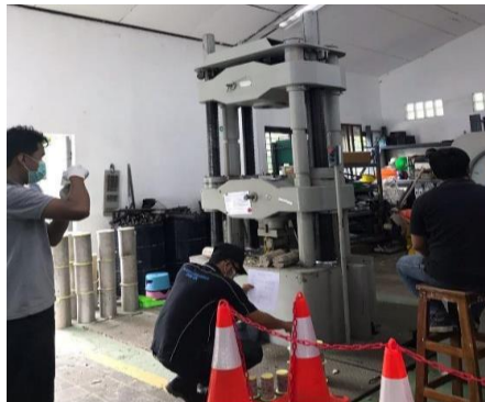
Gambar 7. Pengujian kuat tekan untuk batako dan paving
