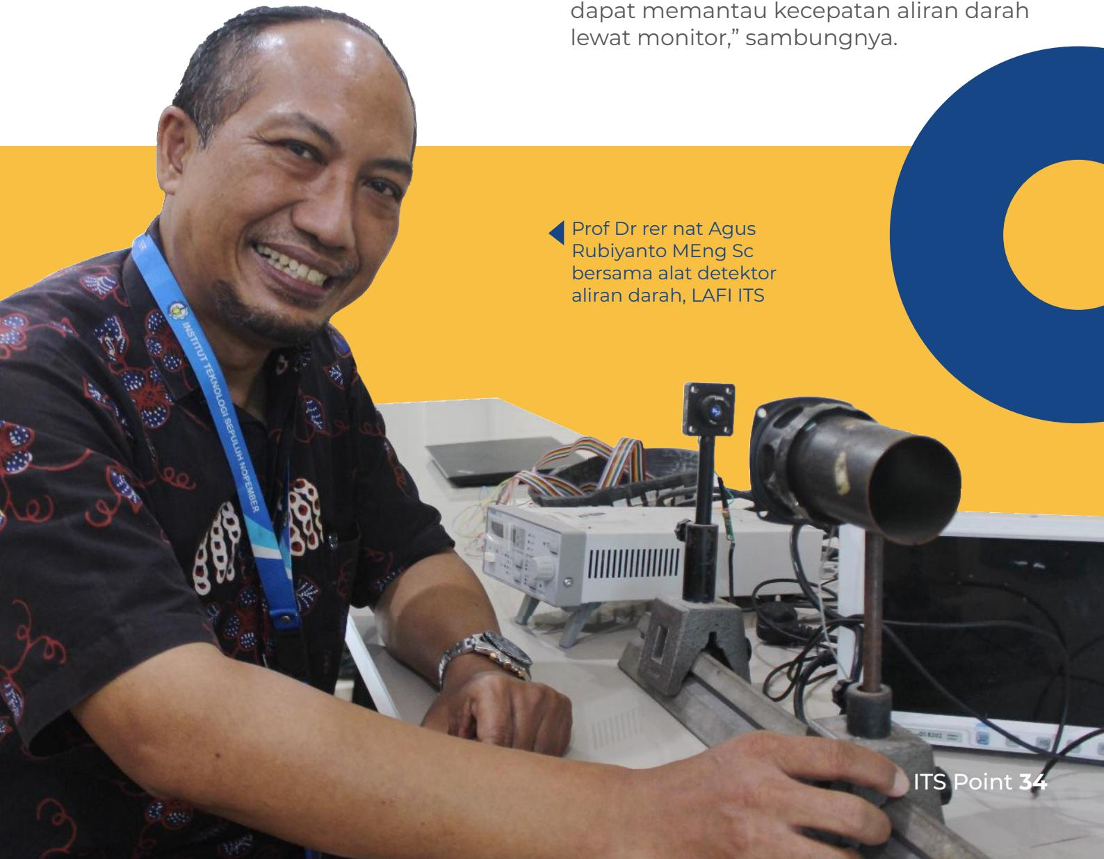
Pada saat bersamaan, laser diode akan menembakkan cahaya ke arah cermin. Cahaya ini akan ditangkap oleh fotodiode yang sudah terintegrasi dengan laser diode. Selanjutnya, cahaya bergerak menuju *driver laser* untuk pengolahannya menjadi grafik data kecepatan aliran darah yang dapat dipantau melalui monitor komputer.
