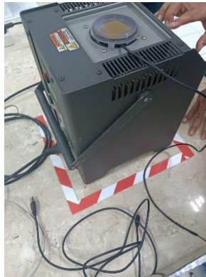
Gambar 4.4.1 Sensor Dimasukkan pada Kalibrator Sumber : Dokumentasi Pribadi
