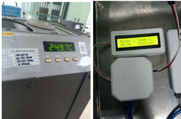
Gambar 4.4.2 Hasil Kalibrasi Sensor Sumber : Dokumentasi Pribadi
