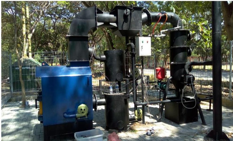
Gambar 2 Prototipe Insenerator Pembakar sampah plastik non reusable ramah lingkungan
