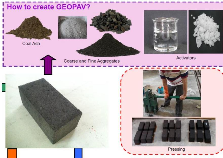
Gambar 1 Pemanfaatan fly ash PLTU sebagai bahan paving Block atau GeoPav
