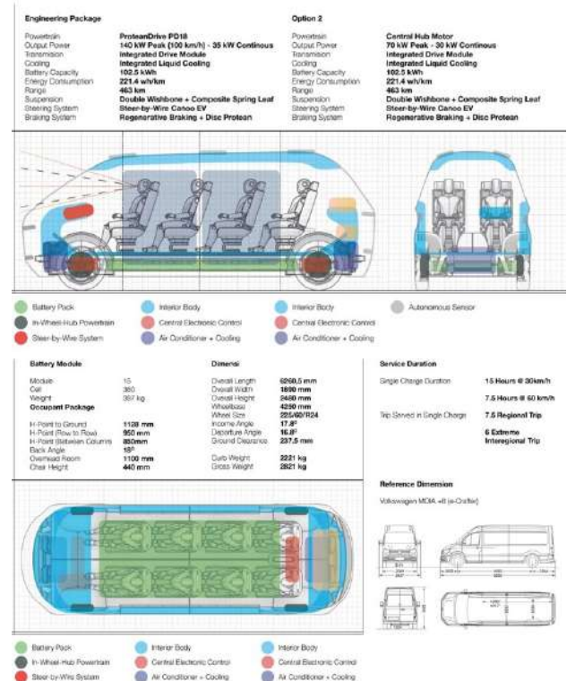
Gambar 12. Menunjukkan Package Drawing beserta Engineering Package Kendaraan Perancangan. Sumber : Penulis
