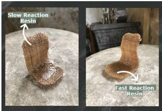
Gambar 5. Pembuatan Bio-Komposit Serat Goni dengan Menggunakan Resin Reaksi Cepat dan Lambat
