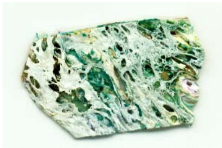
Gambar. 6 Hasil eksperimen pembersihan kandungan minyak menggunakan BENZEN
