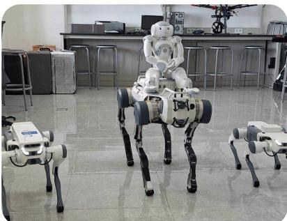
Institut Teknologi Sepuluh Nopember (ITS) kian mengukuhkan kiprahnya di bidang teknologi robotika melalui pengembangan Robot Anjing Berkaki Empat yang terintegrasi dengan sistem sensor, navigasi, dan kecerdasan buatan atau Artificial Intelligence (AI). Robot ini mampu bergerak secara mandiri, menginspeksi area industri, dan menerima perintah verbal.
