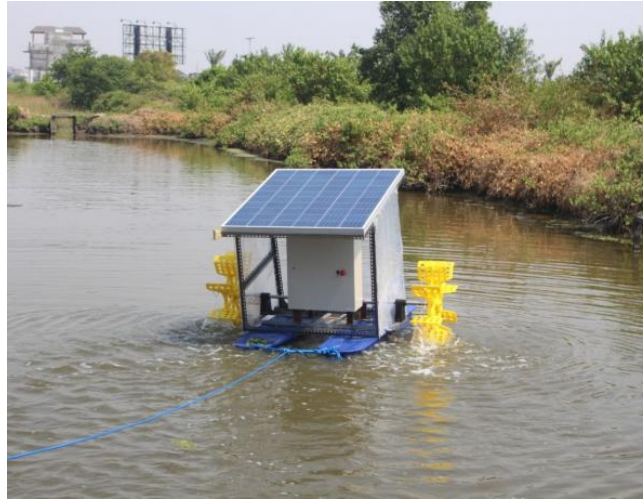
Aerator berbasis fotovoltaic, ciptaan Tim KKN PM ITS sedang bekerja memberikan pasokan oksigen di salah satu tambak petani udang putih Desa Gunung Anyar Tambak, Surabaya
